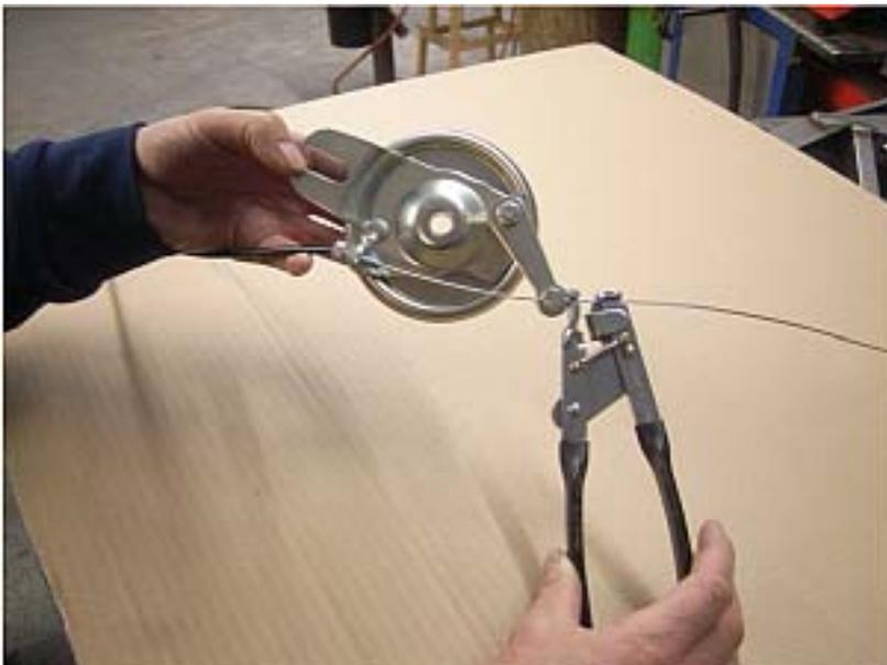
Abb.6 Einstellen der Trommelbremsen mit Hilfe der Spezialzange (Als Zubehör erhältlich)
