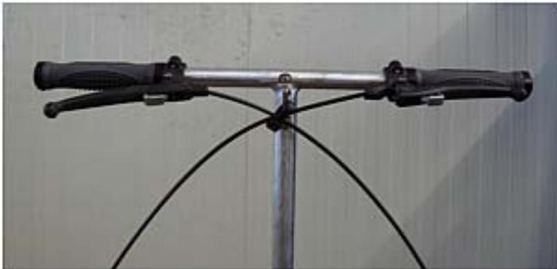
Abb. 4 Handbremsgriffe figur 4 brake levers
