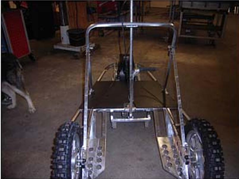
Abb.3 Fixieren mit der Schlittenbremse figure 3 Locking the cart with the sledge brake
